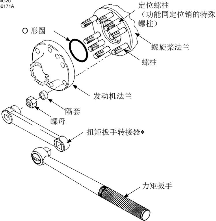
\*注意: 如果使用扭矩扳手转接器, 则采用图 3-1 的计算方法确定正确的扭矩扳手设置
