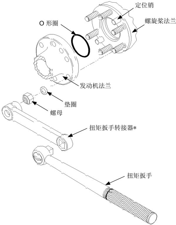
\*注意： 如果使用扭矩扳手转接器，则采用图 3-1 的计算方法确定正确的扭矩扳手设置
