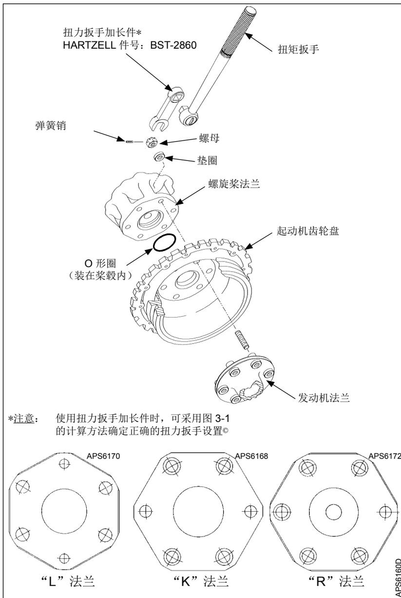
“L”、“K”和“R”法兰螺旋桨安装 - 图 3-9
