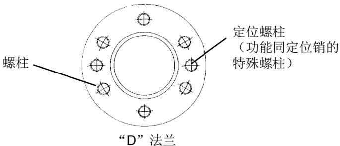
“D” 法兰螺旋桨安装
