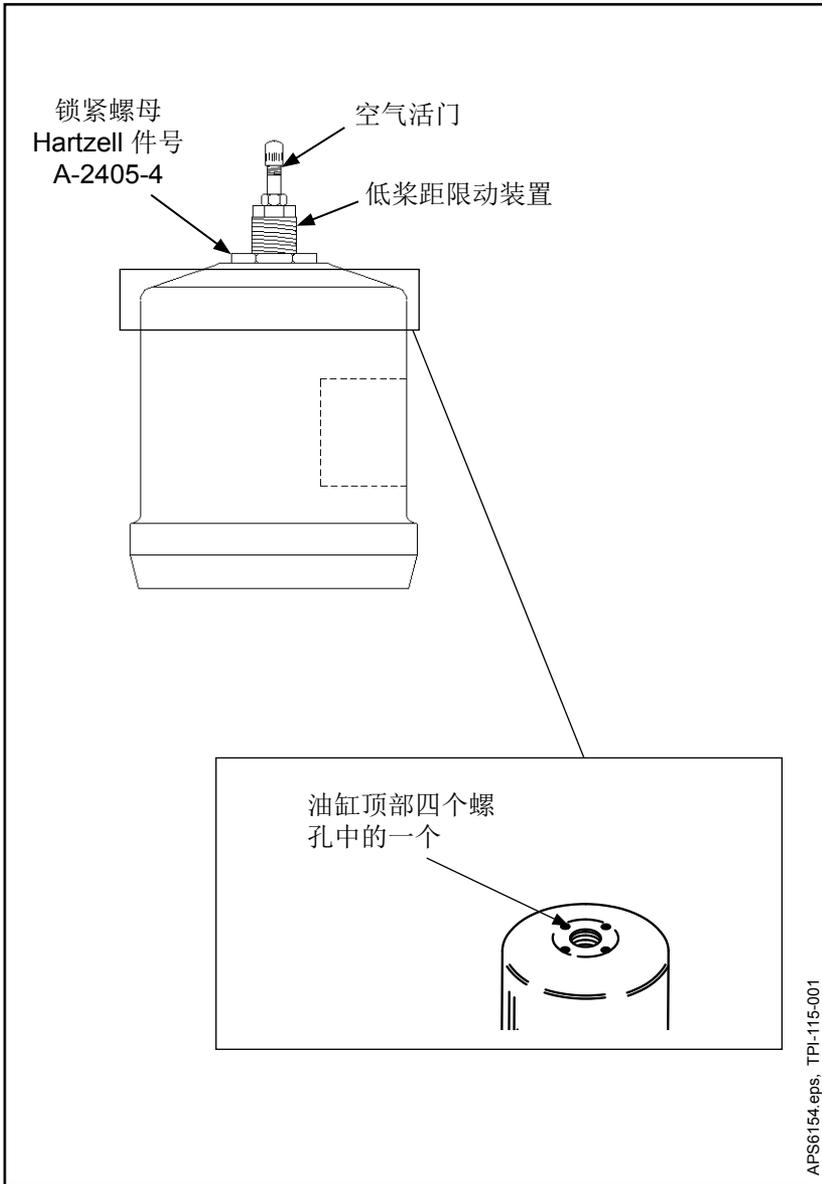
采用整体式桨帽的螺旋桨低桨距限动装置调节(-2, -5)
